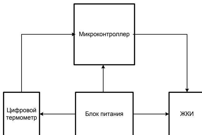
Рисунок 1 – Структурная схема устройства.
