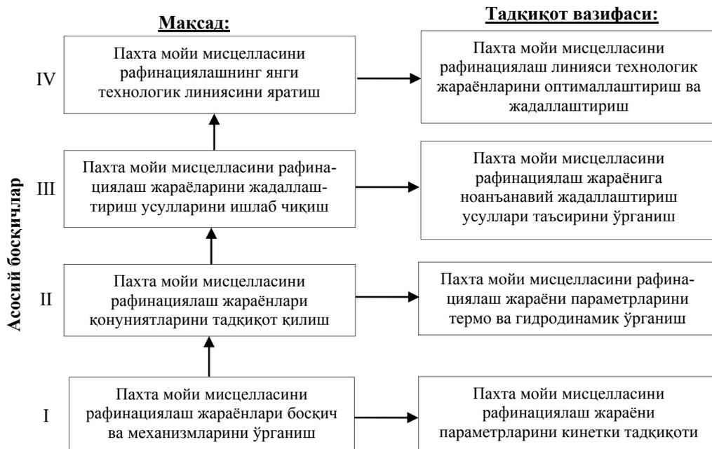
**Расм. 1. Пахта мойи мисцелласининг рафинациялаш технологик линиясини тизимли тадқиқотлари схемаси.**
