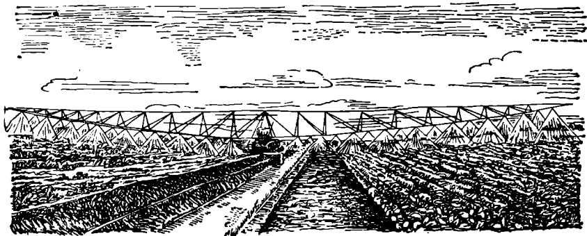
32- расм. Икки консолли ДДА—100 МА маркали ёмғирлатиш агрегати.
