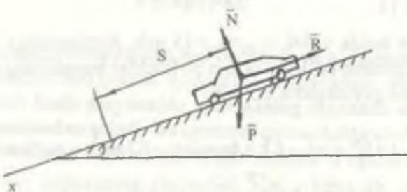
Avtomobilga qo'yilgan kuchlarning teng ta'sir etuvchisining A ishi, tashkil etuvchi kuchlar ishlaringin algebraik yig'indisiga teng. Og'irlik kuchining ishi  $A(P)=P\cdot h=mgL\cdot \sin\alpha$ ,  $\bar{N}$  normal reaksiyaning ishi  $A(N)=0$  ga teng, chunki u avtomobilning harakat yo'nalishiga perpendikulyar; tormozlash  $\bar{R}$  kuchning ishi:
