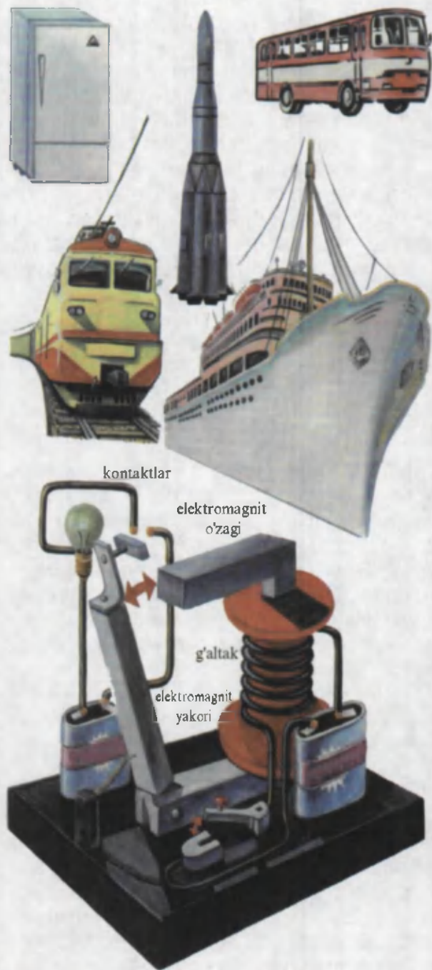
Elektromagnit rele. Uning g'altagi orqali tok o'tkazilsa, yakor o'zakka tortilib, kontaktlar birikadi va lampochka yonadi.
