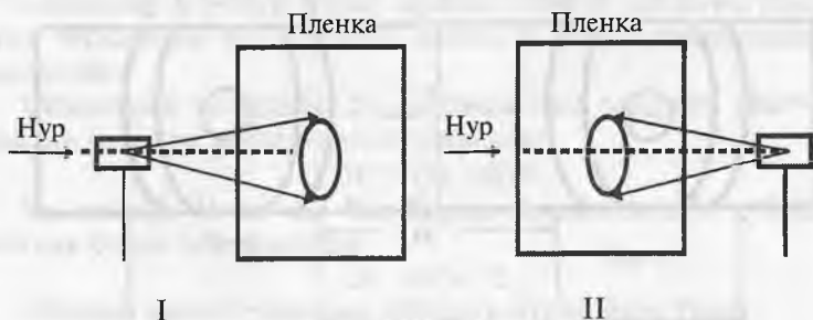
58-расм. Ясси плёнкага тасвир туширишда рентген нури йўналиши, намуна ва плёнкаларни жойлаш схемалари: 1-нур ўтишига асосланган; 2-нур қайтишига асосланган.
