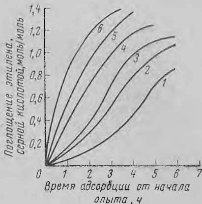
Рис. 185. Влияние давления на степень насыщения серной кислоты этиленом:
