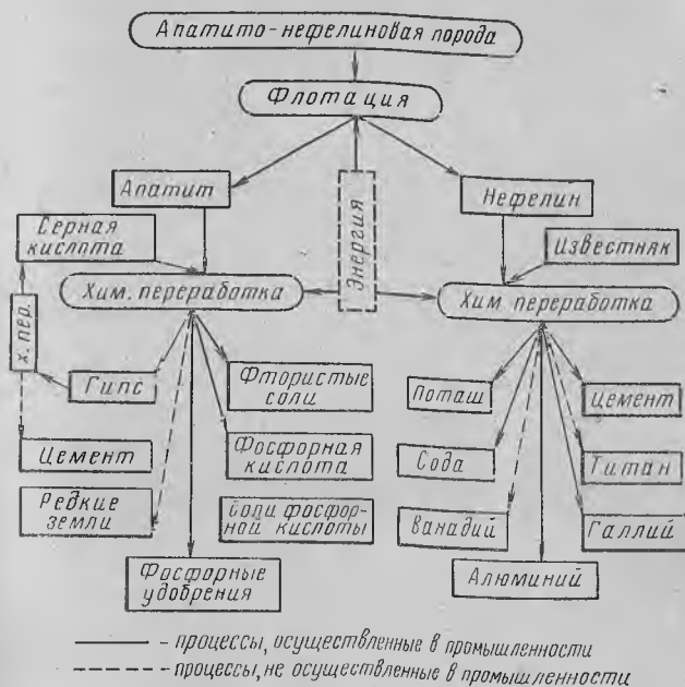
Рис. 10. Схема комплексного использования апатито-нефелиновой породы
