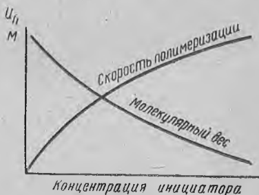
Рис. 205. Зависимость скорости полимеризации и молекулярного веса полимера от концентрации инициатора
