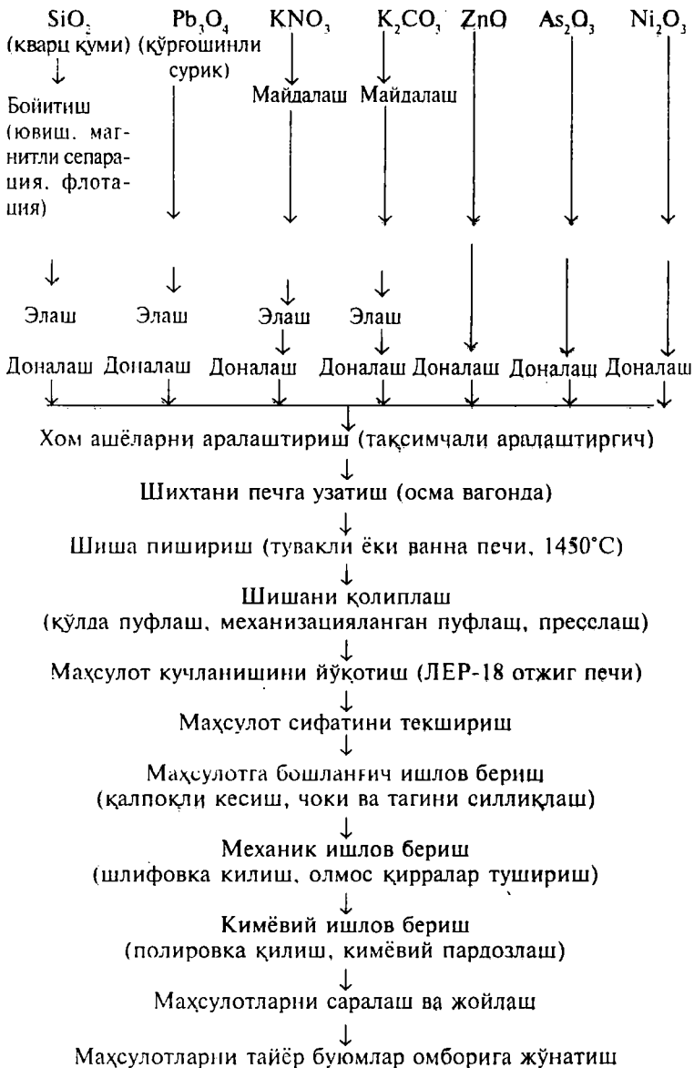
16- расм. Қўрғошинли биллур маҳсулотлар ишлаб чиқаришнинг технологик схемаси.
