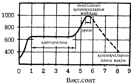
34- расм. \text{GeO}_2 ни қайтариш шароити ва ундаги германийли қошиқчанинг ўчоқда ҳаракатланиши.
