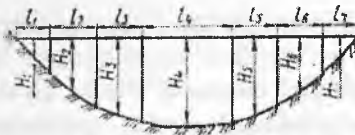
6.33-rasm. To'g'on tanasi orqali o'tadigan umumiy filtratsiya sarfini aniqlash hisobiy sxemasi.
