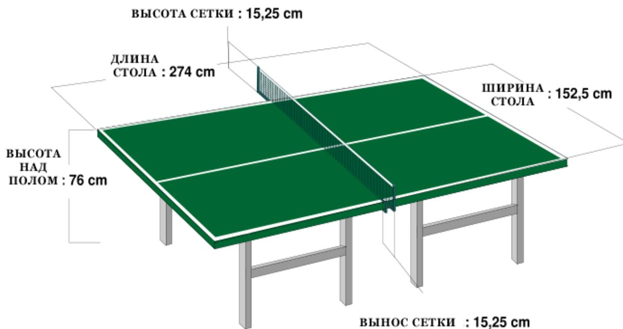
Рис. 43 Вид и размеры теннисного стола.
