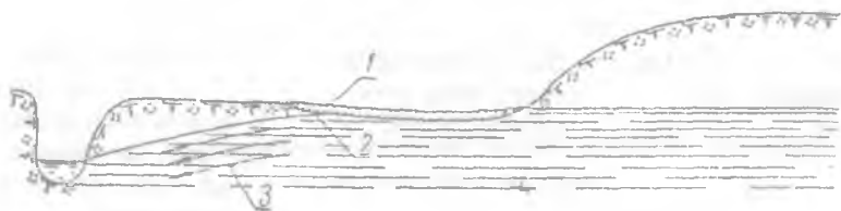
3.2.33-rasm. Sizot suvlari yer yuzasiga yaqin joylashgan yerlardagi botqoqlanish jarayoni: 1–botqoqlangan yer; 2–sizot suvlarning joylashuv yuzasi; 3–sizot suvlarining oqim yo‘nalishi.
