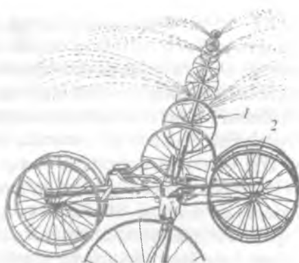
5.1.6-rasm. DKG-80 «Oka» yomg'irlatgich mashinasi: 1-yomg'irlatgich truboprovodi. 2- yurg'izish qurilmasi.
