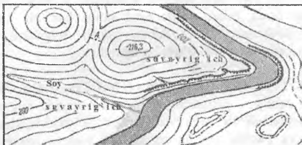
2.5-rasm. Gorizontallar yordamida tasvirlangan topografik xarita
