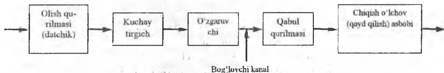
2.55 – rasm. Dozimetrlar ishlash prinsipining umumiy sxemasi
