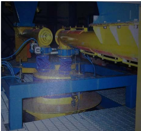
13- Rasm. Ikki komponentli shnekli universal dozirovka kompleksi KDU-SH (avtomat tarozi va shnekli aralashtirgich).
