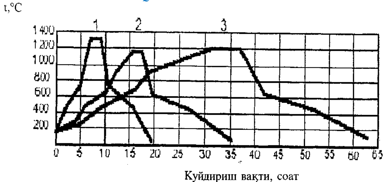
25-rasm. Tunnel pechlarida amalga oshiriladigan kuydirish tizimlari: 1-chinni tarkibli sanitariya-qurilish buyumi; 2-kislotaga chidamli g'isht; 3-diametri 250 mm li keramik quvurlar.
