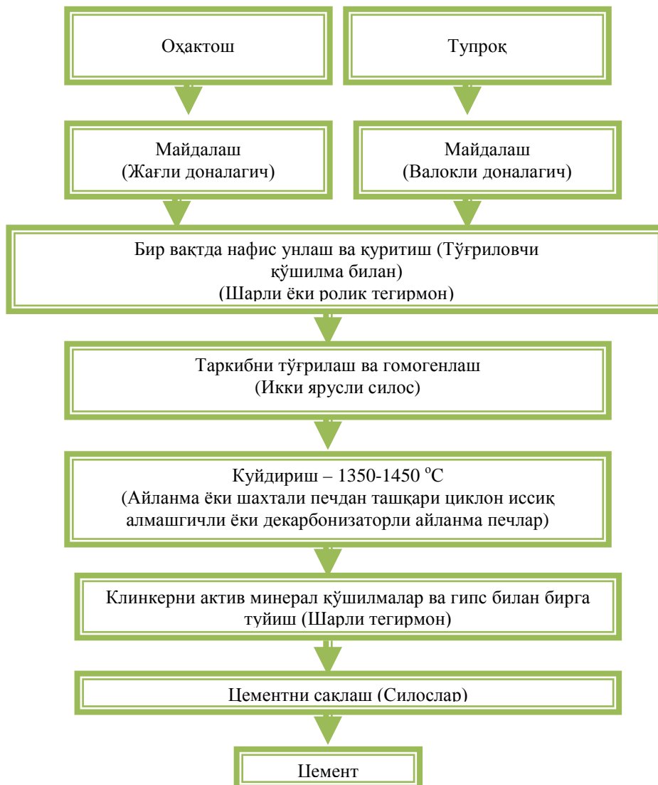
Қуруқ усул бўйича портландцемент ишлаб чиқаришнинг соддалаштирилган технологик схемаси.
