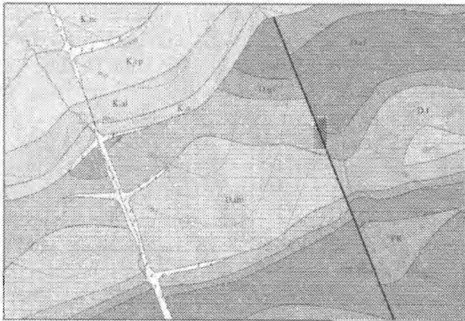
91-rasm. Yer yoriqlari bilan murakkablashgan sinklinal va antiklinal burmalarning geologik xaritada tasvirlanishi. Pt-proterozoyning kristallangan slaneslari, D_{2ef} -o'rta devon eyfel yarusi kvarsitlari, D_{2gv} -jivet yarusi gilli slaneslari, D_{3fr} -yuqori devon fran yarusi mergellari, D_{3fm} -famen yarusi bitumli ohaktoshlari, K_{1a} -quyi bo'r apt yarusi fosforitli gillari, K_{1al} -alb yarusi temirli qumtoshlari, K_{2cp} -yuqori bo'r kampan yarusi gillari, K_{2m} – maastrixt yarusi mergellari.
