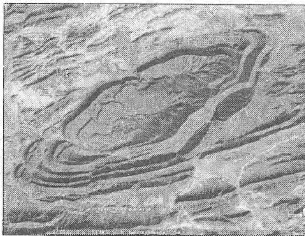
92-rasm. Aerofotosuratda burmali strukturaning tasviri.
