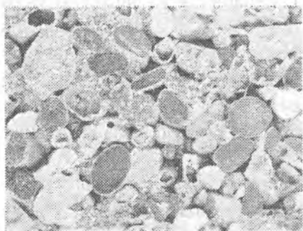
185-rasm. Konglomeratning karbonatli sementi.
