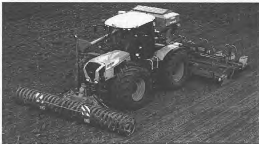
1.4-rasm. Claas firmasining Xerion modeli traktori bazasida agregat yerni yumshatish va urug‘ ekish jarayonida.
