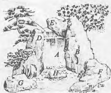
2.4.11-rasm. Yapon bog'i sharsharasining sxemasi: A – asosiy tik sharshara toshi, B, D – yonbosh toshlar; E – suv oqimini bo'luvchi tosh, F, G – sharshara etagi va hovuzining toshi; H – sharshara suvi va to'liqlarini ajratuvchi tosh.
