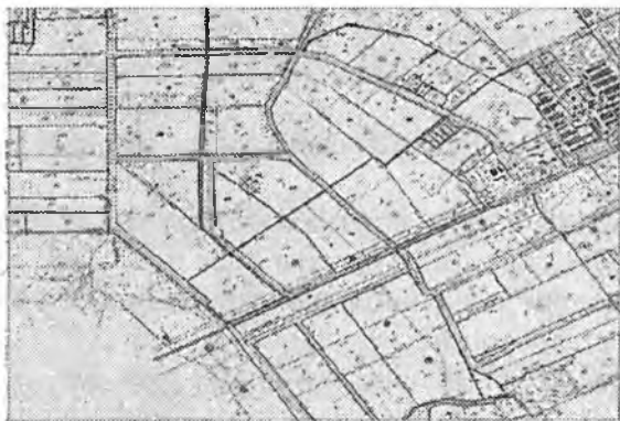
57-rasm. Aero va kosmik suratlar asosida zaruriyatiga qarab 1:10000,1:25000, miqyosda deshifrovka ishlarini bajarish uchun tayyorlanadigan fototarx
