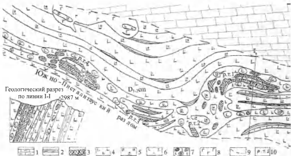
Рис. 14. Схематическая геологическая карта месторождения Чимкурган (по А.Г.Сафарову, Л.М.Крикуновой, 1999 г.). Вулканогенно-осадочные отложения чимкурганской свиты ( D_{1,2} см): 1 – известняк глинистый; 2 – переслаивание аргиллитов с алевроаргиллитами; 3 – магнетит-гематитовые рудные тела; 4 – диабазы неравномерно порфировые; 5 – базальты миндалекаменные; 6 – диабазы афировые; 7 – шаровые лавы базальтоидов; 8 – габбро; 9 – тектонические нарушения; 10 – номер рудного тела.
