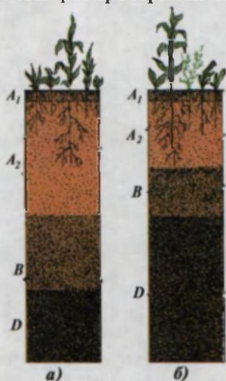
Рис. 24. Почвенные разрезы: а) светлый серозем; б) типичный серозем;  $A_1$  — пласт накопления перегноя;  $A_2$  — промывочный пласт;  $B$  — пласт накопления веществ;  $D$  — материнская порода почвы.
