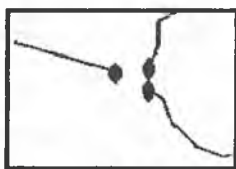
35-rasm. Operator xatolari: "a" nuqtalar oxirigacha yetkazilmagan, "b" chiziqlar ikki marta o'tkazilgan
