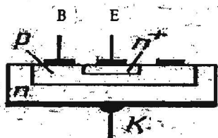
III.70-rasm. Diffuzion-planar tranzistor tuzilmasining umumiy ko'rinishi
