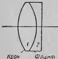
273-расм. Хроматизми тузатилган мураккаб линза.
