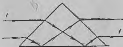
12-расм. Тўла ички қайтиш призмаси ёрдами билан нурларнинг ўнгарилиши.
