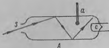
39-расм. Ёруғлик энергия оқимини абсолют ўлчаш методи.
