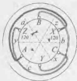
IX.7-расм. Статор чулғамининг тузилиш принципи.
