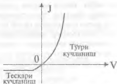
11.20- чизма. Металл-ярим ўтказгич контактининг вольт-ампер тавсифномаси.
