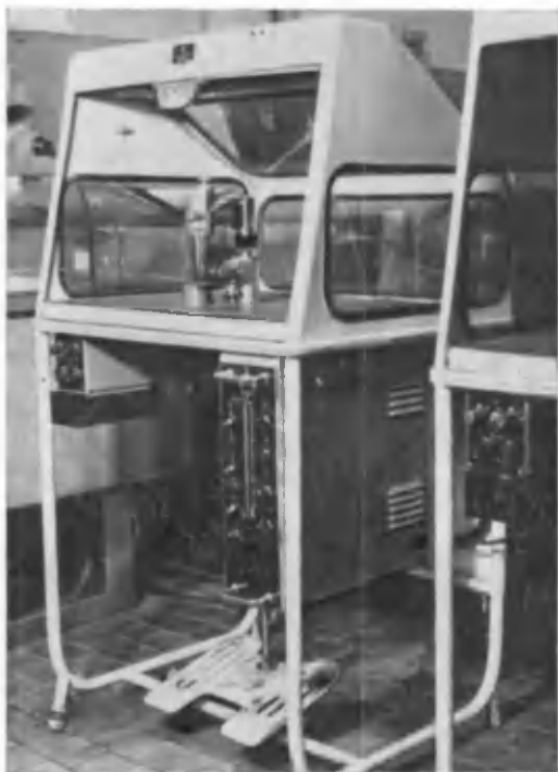
Рис. 219. Внешний вид монтажно-сварочного стола
