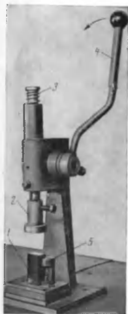
Рис. 163. Приспособление для завальцовки футляров батарей «Крона-1Л»:
