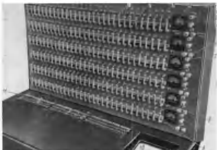
Рис. 232. Разрядный стенд для элементов РЦ-31 и ЧМЦ-2:
