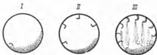
Рис. 72. Разновидности конструкции барабанных сушильных печей
