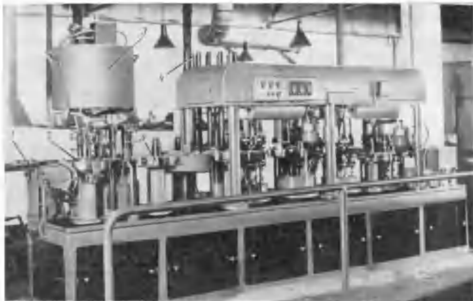
Рис. 139. Роторная машина заливки изолирующей композиции, вставки верхней шайбы, надевания и завальцовки футляра элемента № 373:
