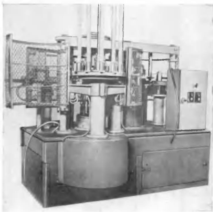
Рис. 138. Роторная машина нанесения галтели на отрицательный электрод элемента № 373 и вставки нижней шайбы
