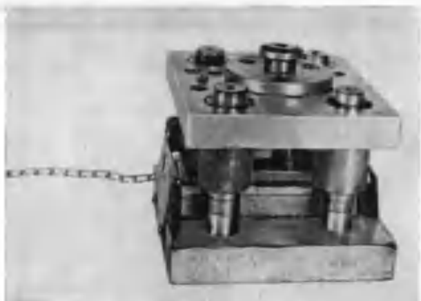
Рис. 97. Штамп для изготовления заготовок контактов батареи «Крона-1Л»
