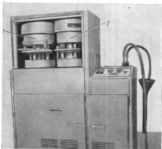
Рис. 206. Автомат запрессовки активной массы в корпус ртутно-цинкового элемента:
