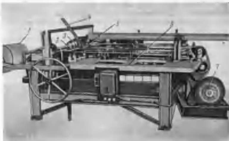
Рис. 90. Автомат склеивания трубок из кабельной бумаги для футляров элементов № 373:
