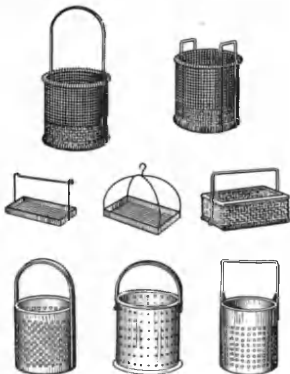
Рис. 190. Решетчатые корзины для обезжиривания деталей перед гальваническим покрытием
