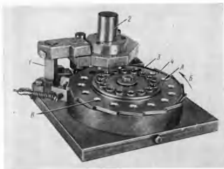
Рис. 98. Штамп для вытяжки контактных клемм батареи «Крона-1Л»:
