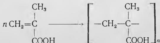
Полиметакрил кислота оқ ёки тиниқ полимер. Сувда ва ишқор эритмаларида яхши эрийди. У турли органик суюқликлар ва концентрланган минерал кислоталар таъсирига чидамли. Полиметакрил кислотанинг молекуляр массаси 80 000—100 000 атрофида. У аморф полимерлар жумласига киради. Молекуляр массаси билан қовушоқлик ҳадди ўртасидаги боғлиқлик  $[\eta] = 6,6 \cdot 10^{-4} M^{0,5}$  билан ифодаланади.
