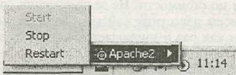
Рис. 10. Запуск (а) и остановка (б) сервера Apache при помощи собственной программы-диспетчера
