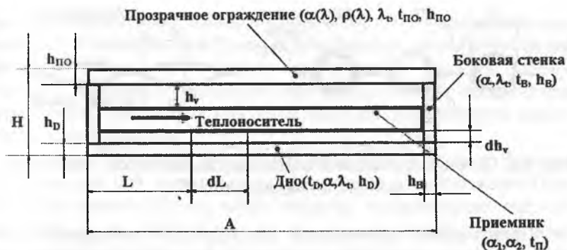
Рис. 9.5. Конструктивные элементы и основные теплотехнические параметры солнечного водонагревательного коллектора.
