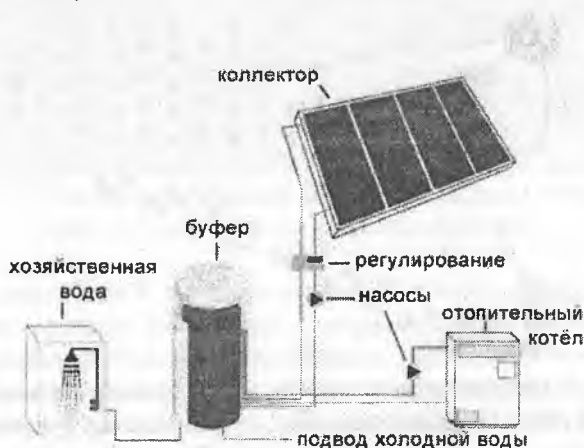
Рис. 9.4. Схема солнечной установки для горячего водо- и теплоснабжения с дублиром: солнечный коллектор, системы управления, насосы и бак – аккумулятор (буфер), отопительный котел.
