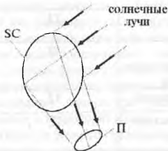
Рис. 8.6. Схема работы концентратора солнечного излучения.
