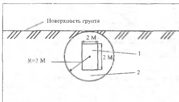
Рис. 1.3. Поперечное сечение траншейного овощехранилища: 1—траншея; 2—объем грунта
