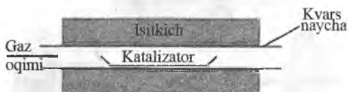
3.24- rasm. Fulleren va nanonaychalarni bug'dan kimyoviy cho'ktirish yo'li bilan oluvchi qurilma sxemasi.
