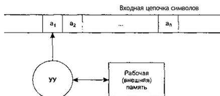
Рис. 1.2. Условная схема распознавателя
