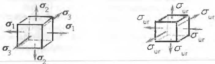
3.23-rasm. Bosh normal va o'rtacha kuchlanishlar bilan yuklangan kubiklar.
