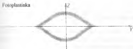
18.7-rasm. Shtern-Gerlax tajribasida kumush atomlarini fotoplastinkada joylanishi.
