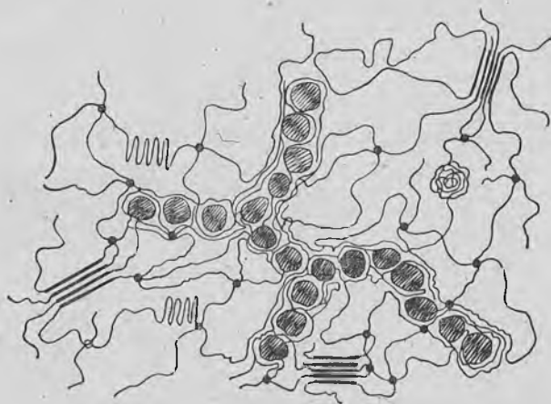
Рис. 1.16. Структура линейного полимера, содержащего активный наполнитель и сшитого химическими поперечными связями (резина).
