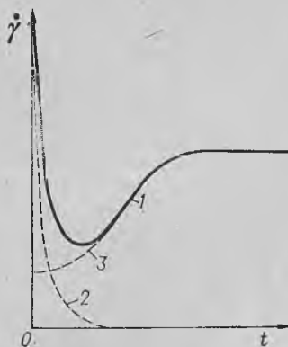
Рис. V.10. Временные зависимости полной сдвиговой деформации (1) и ее высокоэластической (2) и вязкой (3) составляющих для эластомеров при постоянном напряжении сдвига P .
