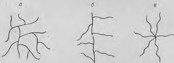
Рис. 1.2. Схемы строения разветвленных макромолекул: а — статистической; б — гребнеобразной; в — звездообразной.
