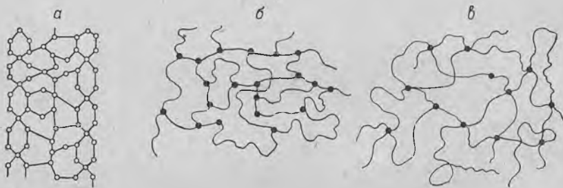
Рис. 1.3. Схемы строения микросетчатого (а), макросетчатого разветвленного (б) и макросетчатого сшитого (в) полимеров.
