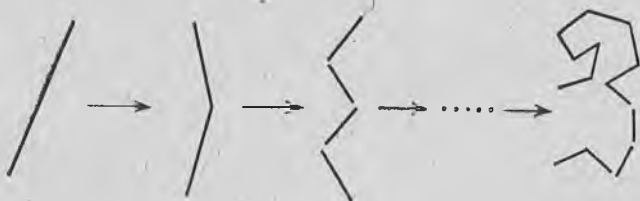
Рис. I.9. Переход (по Флори) к сегментальной модели путем последовательных изломов стержневидной цепи.
