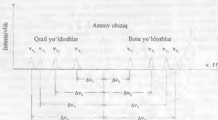
5.6-rasm. Yorug'likning kombinatsion sochilishida yo'ldoshlarning (satellitlarning) paydo bo'lishi chizmasi.
