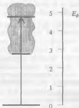
6.5-rasm. Proton va neytron sistemasining energetik sathlari, yo'nalishli vertikal chiziq deytronning fotoparchalanishini xarakterlaydi.
