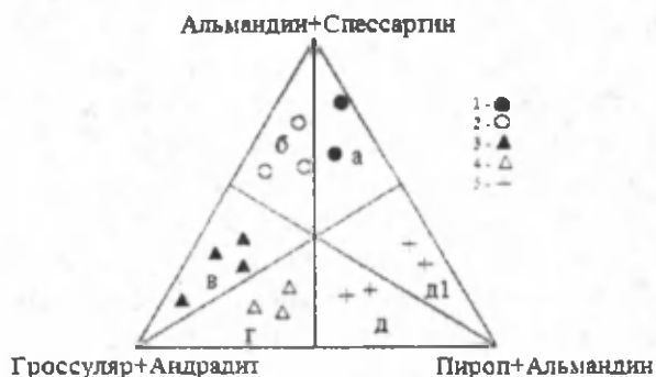
Рис. 15. Состав аксессуарных гранатов, представленный в виде отношений конечных молекул из гранитоидов различных геодинамических условий. Поля гранатов: а – офиолитовой ассоциации, б – субдукционной обстановки, в – из древних коллизионных гранитов, г – из молодых коллизионных гранитов, д и д1 – из скарнов и гранито-гнейсов. гранат: 1 – из габбро-плагиогранитов, 2 – из гранодиоритов, 3 – древних (s) гранитов, 4 – молодых (p) аляскистов, 5 – из метаморфических пород (pt) и скарнов.
