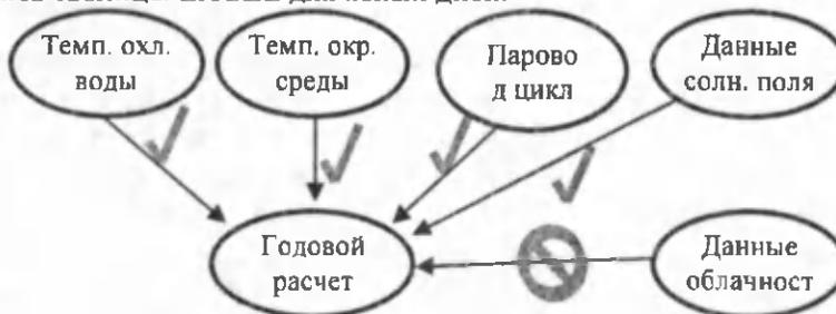
Рис. 3. Факторы, учитываемые при расчете СДТЭС.
