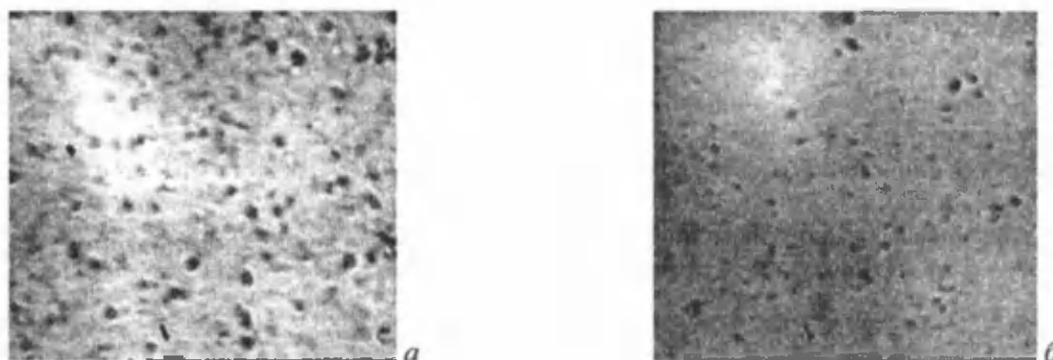
Рис. 1. Микрофотографии образцов кремния: а – образец, легированный серой при  $1150^\circ\text{C}$ ; б – образец, легированный родием при  $1150^\circ\text{C}$ . (на вставках приведена микрометрическая шкала с шагом 10 мкм).
