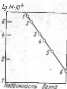
Рис. 25. График зависимости \lg M от подвижности белка для определения молекулярной массы методом электрофореза в ДСН-полиакриламидном геле:
