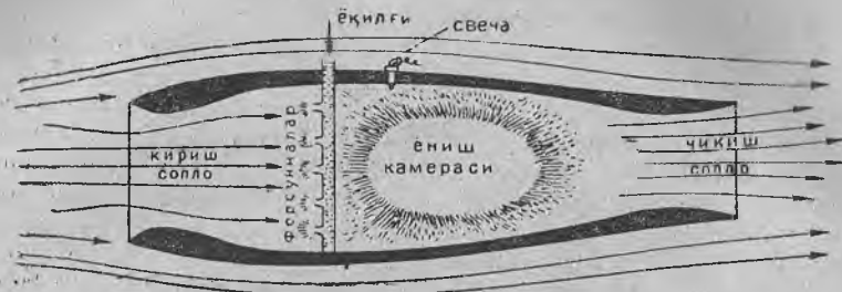
215-расм. Тўғри оқимли ҳаво-реактив двигателнинг схемаси.
