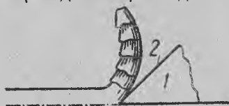
9-расм. Қириндининг ҳосил бўлиш схемаси.
