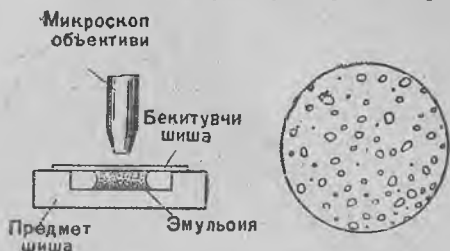
119-расм. Броун ҳаракатини кузатишда фойдаланиладиган қурилманинг схемаси (чапда), ўнг томонда микроскопда кузатиладиган ҳаракат қилаётган зарралар.
