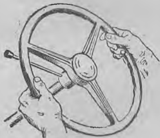
40- расм. Машина ҳайдовчи қўларининг руль ғилдирагига таъсири жуфт куч ҳосил қилади.
