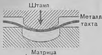
173-а расм. Штамповка схемаси.
