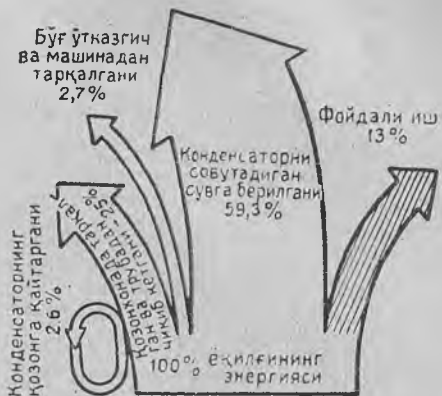
198-расм. Буғ-куч қурилмасида энергиянинг сарф қилиниш диаграммаси.
