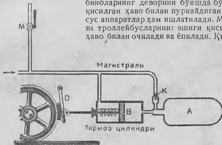
142-расм. Темир йўл пневматик тормозининг тузилиш схемаси.
