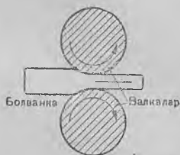
173-в расм. Прокатка схемаси.
