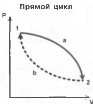
Рис. 10.9 По часовой стрелке. A > 0 . Тепловой двигатель.
