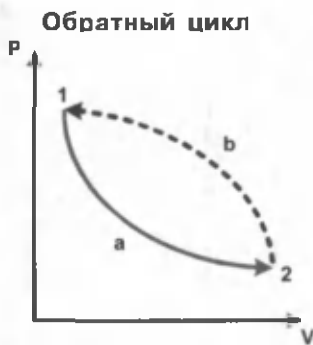
Рис. 10.10 Против часовой стрелки. A < 0 . Холодильная установка.
