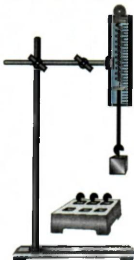
Рис. 67. Принадлежности для определения жесткости пружины.
