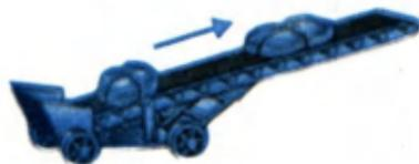
Рис. 80. Поднятие груза наверх с помощью транспортера.
