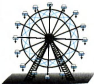
Рис. 13. Поступательное движение кабинок «чертова колеса».
