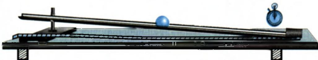
Рис. 41. Установка для определения ускорения при равноускоренном движении.
