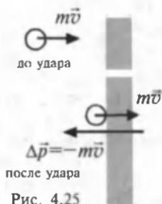
При неупругом ударе о стенку изменение импульса равно  $|\Delta p| = |mv|$ , (рис. 4.25).
