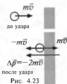
При перпендикулярном (лобовом) абсолютно упругом ударе в стенку шар отражается и летит в противоположную сторону с тем же импульсом. Изменение импульса шара (и стенки) равно  $|2mv|$  (рис. 4.23).
