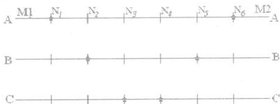
2.11- rasm. Oltita nimstansiyali tortuvchi tarmoqning ikki tomonlama manbadan ta'minlanayotgan elektr uzatish liniyasiga nisbatan tekis yuklama sifatida ulanishi uchun eng kam yuklangan fazalar ketma-ketligining almashlash tartibi
