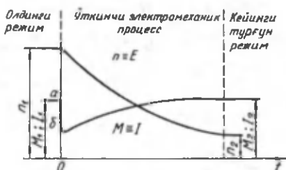
247- расм. Якорь занжирига қўшимча қаршилик киритиб двигательни айланиш частотасини ростилаш жараёни. Бунда: R_{н2} > R_{н1} ;
