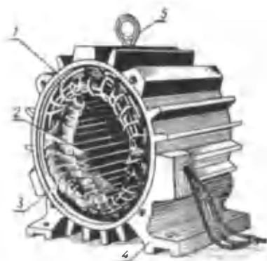
79-расм. Ўзгарувчан ток машина-сининг статори:
