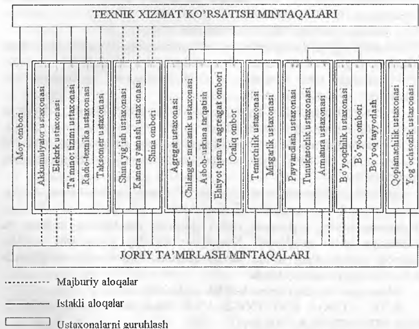
2.3-rasm. Ustaxona va mintaqalar aloqalari sxemasi.
