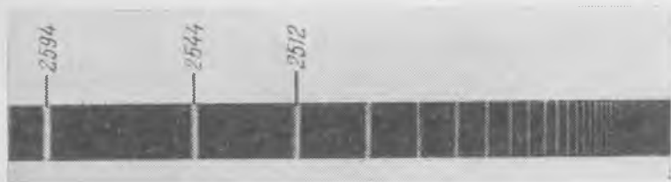
Рис. 29. Спектр поглощения паров натрия. На спектрограмме показана только коротковолновая часть серии, начиная с пятого члена ( \lambda = 2594 \text{ \AA} ).
