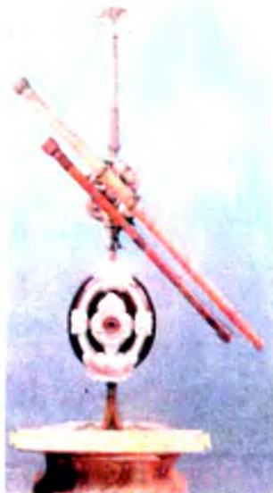
53- rasm. Galiley yasagan birinchi teleskop – refraktor.
