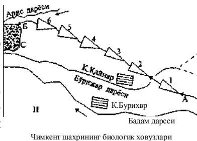
73-расм. Биологик хрвузлар очик, мезоэко система: А— окава сув келадиган коллектор; 1—6-\овузлар; Б—окава сув кетадиган канал; С— эким экиладиган майдон
