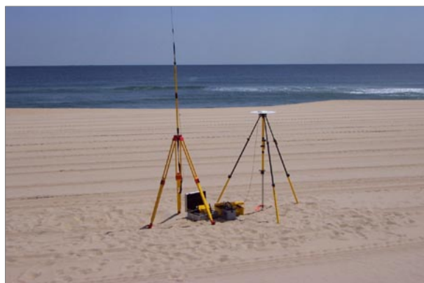
1.7-расм. GPS услубида жойда нуқтанинг планли координаларини аниқлаш усули; GPS асбоблари
